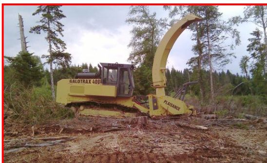
Galotrax 400 équipé d'un broyeur récupérateur de biomasse
